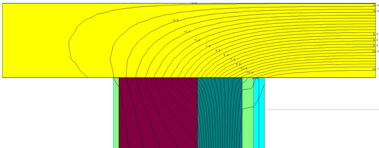
L'immagine sottostante mostra il nodo copertura sufficientemente corretto con blocco in gas Beton sull'ultimo corso mattoni. L'isoterma critica sfiora ma non tocca la superficie interna.
